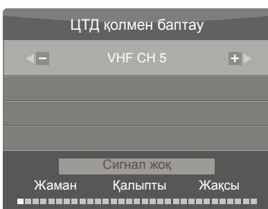
ЦТД параметрлері экраны пайда болады. Қажетті арнаны "▼▲" арқылы таңдал, іздеуді бастау үшін ОК түймесін басыңыз.
